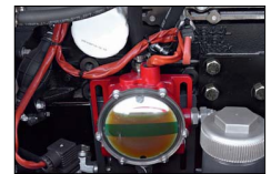
Dispositivo di rabbocco automatico olio Automatic lube oil refuelling system Remplissage automatique de l'huile Sistema de recarga automática de aceite
