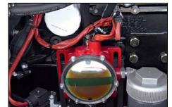
Dispositivo di rabbocco automatico olio Automatic lube oil refueling system Remplissage automatique de l'huile Sistema de recarga automática de aceite
